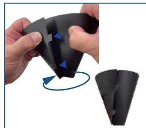
① 漏斗を丸め、2か所の爪部をそれぞれ上側から切り込み部に差し込む。適宜テープ等で固定する。
