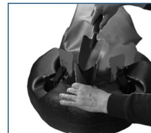
② ベースの蓋を外し、漏斗とスコップを使用して砂約 40kg または満水（約 30L）を充填する。充填後蓋を閉める。
